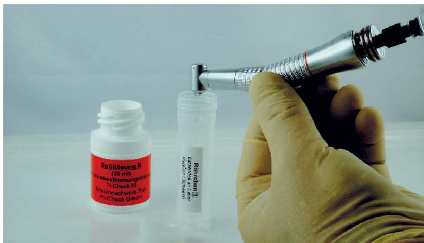
**Abbildung 1** Spülung eines Winkelstücks mit SDS-Lösung zur Gewinnung der Elutionsflüssigkeit für die Bestimmung des eluierbaren Proteingehalts aus dem Inneren des Übertragungsinstrumentes.
