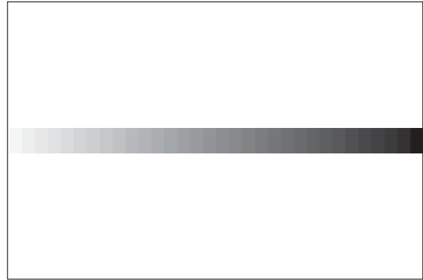
Abb. 5 Graustufenauflösung bei 5 bit, d. h. 2^5 = 32 Graustufen. Schwarz (ganz rechts) hat per definitionem unabhängig von der Speichertiefe immer den Wert 0
