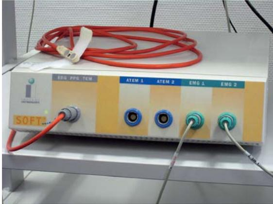
**Abb. 1** Beispiel eines Biofeedbackgeräts (SOFT®med Comfort 8.02, Insight Instruments, Salzburg, Österreich).
