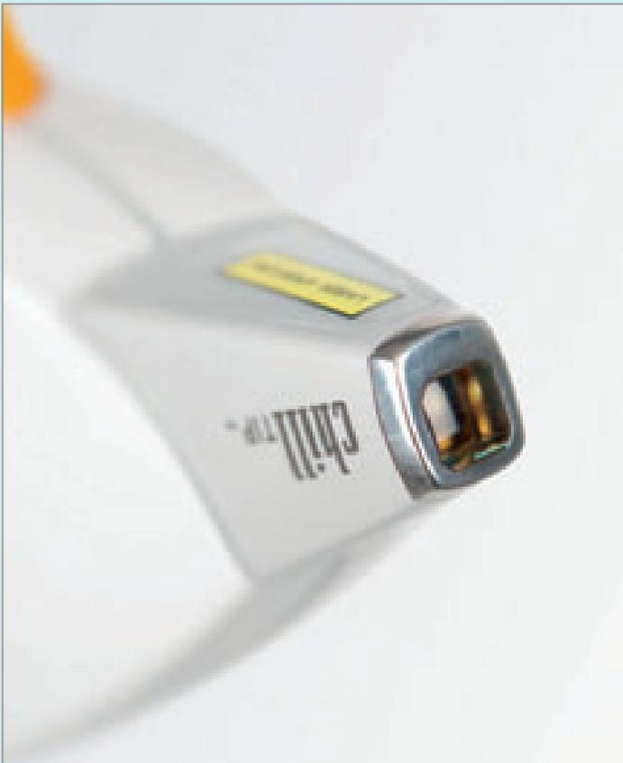
**Abb. 2.165** Beim klassischen High-Fluence-ET-Handstück des LightSheer, welches sich auch beim Duett findet, werden die Energien vieler Diodenarrays mit einem speziellen Spiegelsystem gebündelt und auch ein gekühltes Saphirglas auf die Haut gebracht. Somit können hohe Energien bereitgestellt werden, jedoch ist der Spot sehr klein.
