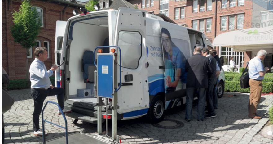
**Abb. 6** Über die Laderampe werden die Patienten sicher ins Innere des Kleintransporters befördert.
